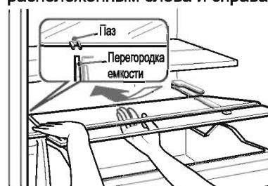
**2** Приподнимите заднюю сторону верхней панели отсека сохранения свежести и вставьте выступ в гнездо.
