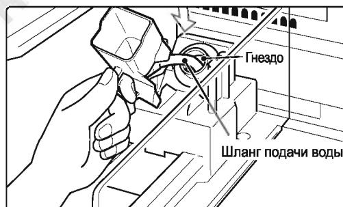
**4** Вставьте шланг подачи воды в отверстие сбоку холодильника до упора.
